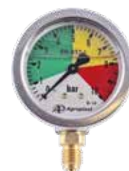
Manometr glicerynowy Mocowanie: M12x1,5 (dolne) Płyn wypełniający obudowę: gliceryna 99.7% Podziałka: od 1 do 10 bar co 0,2 bar Klasa dokładności: 1.6 Zastosowanie: zawory sterujące opryskiwacza , rozdzielacz sekcyny HD 221254
